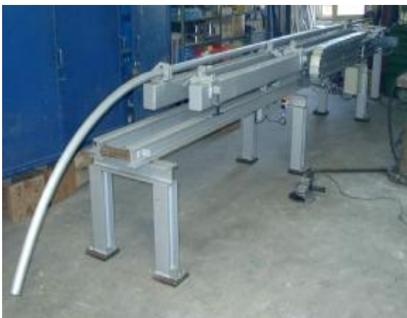
Teleskoparm Drahtführung Flexible wire guide
